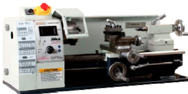
Токарный станок настольного типа имеет диаметр шпинделя 38мм, диаметр над станиной 210мм.
